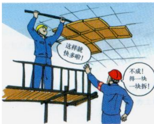
图 11.7.15 不能猛撬拆除模板
