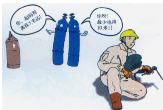
图 11.6.11 乙炔发生器和氧气瓶的安全距离
