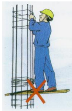
图 11.6.10 禁止插板悬空操作
